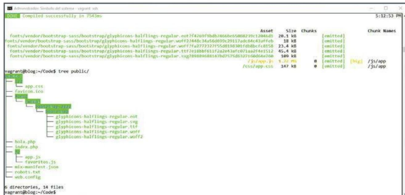
Figura 5. El comando npm run development generó los archivos js/app.js y css/app.css y copió archivos de fuentes.
